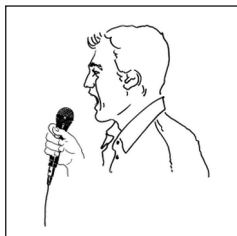
Fig. 1 : Position typique du micro
